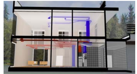
Проект системы воздушного отопления на базе воздухонагревателя «АНТАРЕС Комфорт» для проекта «Хайтек-170»
